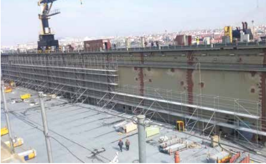
Türkiye'nin ilk çıkarma ve helikopter gemisi Sedef Tersanesi'nde Layher İskele Sistemleri ile inşa ediliyor.
