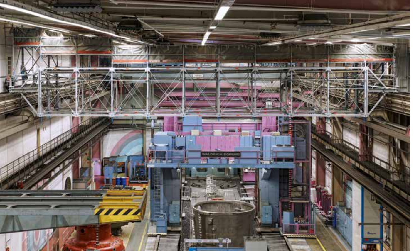
Bir holün köşesindeki mobil çalışma platformu – zemin alanı serbest kalır ve çalışmanın devam etmesini sağlar. Vinç hareketliliği malzeme kullanımını azaltır
